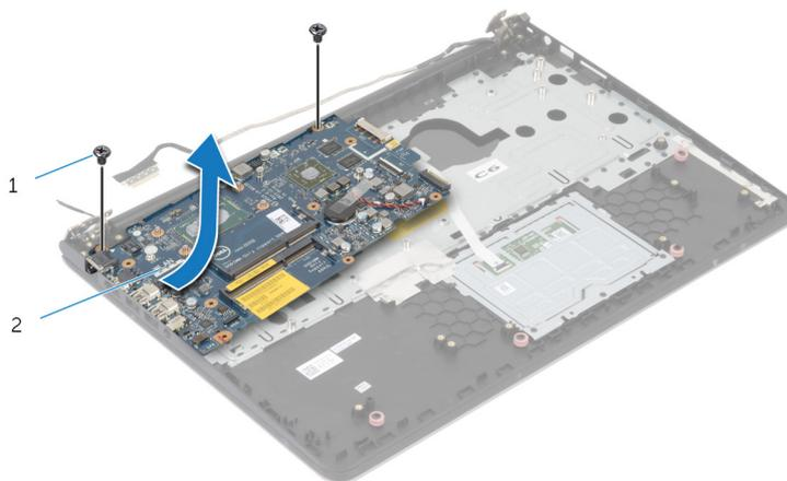
**3** Levante e retire a placa de sistema do apoio para as mãos.
